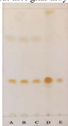
Hình 2: Sắc ký đồ sáp đã tinh chế, sản phẩm thủy phân và policosanol đối chiếu với hệ dung môi n-hexan - EA - CH 3 COOH (90 : 9 : 1)
